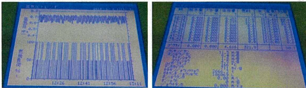
図1 ボイラの間欠運転と効率低下例 (ボイラ負荷率≒燃焼時間率とする)
