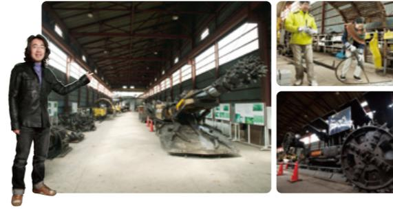
自走枠とは、地下数百メートルに配置されている坑内の採炭切羽の天盤を支え、より安全に、効率よく大量採炭するために作られた大型機械のこと。とても大きいので、一旦解体して坑内に運び、その場で坑内機械員が組み立てて使用していました。坑内では、自走枠が50台~100台並んで使われ、各自走枠は自ら前進していたそうです。実は、現在工場内に展示してある自走枠は、修理のため地上へ上げられていたもので、分解され放置されていたもの。それを、元坑内機械員だった方々が中心となり復元していきました。坑内で使用されていた機械類は、残っていたとしても、そのまま動かせることはまずありません。自走枠工場では空気ドリルを実際に体験できますが、それも元坑内機械員の方々がメンテナンスをしてくれるから。こういった人的資源が、赤平の何よりの特徴です。この自走枠工場は、彼らの経験や知識が詰まった「生きた博物館」と言えるでしょうね。
